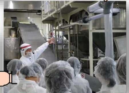
↑ 浸漬後の米はベルトコンベアーで運ばれ、蒸気で炊き上げられる。
