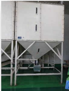
↑ 米を貯蔵するタンク。 米や小麦粉を保管しているので、室内は 20℃に保たれている。
