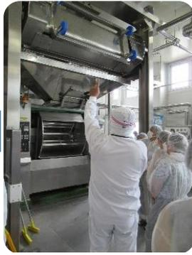
↑ 材料を混ぜ合わせるミキサー
