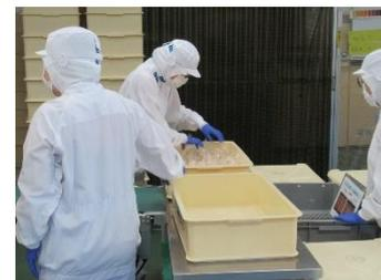
金属検出機を通して異物がないか確認し、最後は人の目で確認します。
