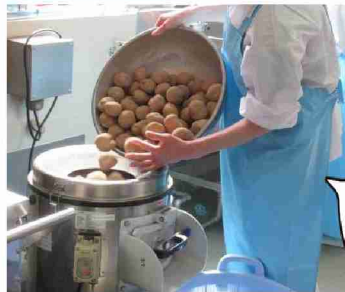
じゃがいもの皮を機械でむきます
